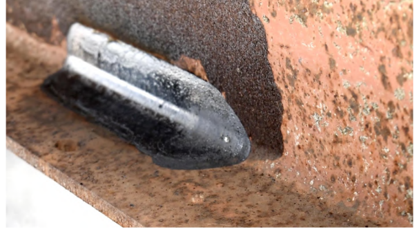
レーザーの高熱で形成された酸化皮膜
